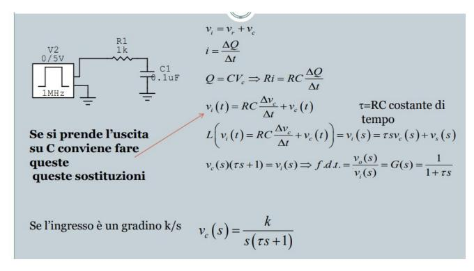
Scopo della trasformata di Laplace: trasformare una funzione di trasferimento da equazione differenziale (derivate, integrali, rapporti incrementali) in semplici polinomi.
